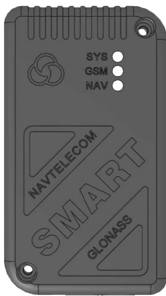
Рис. 3. Системный блок изделий (вид сверху). Индикаторы SYS, GSM, NAV
